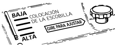
Figura 5 - Ajuste de la Escobilla Principal
